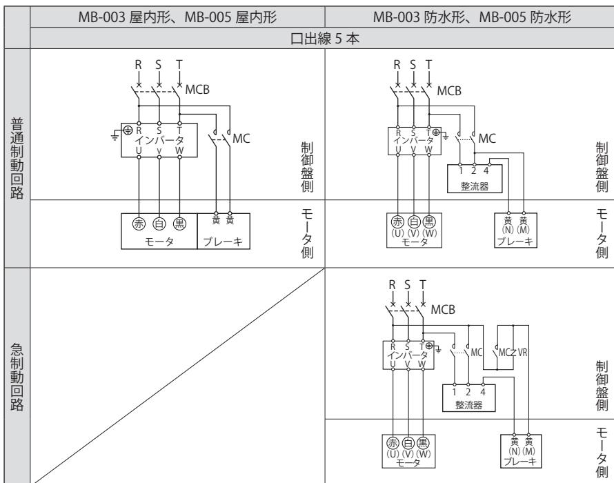
MC : 電磁接触器
