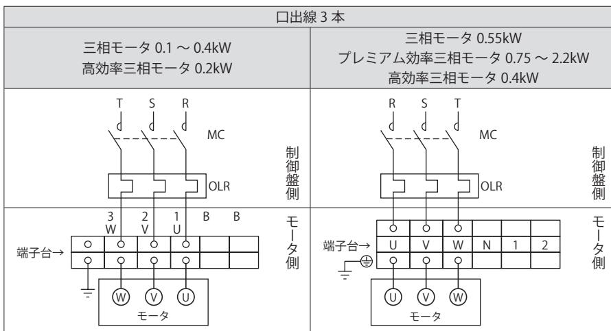
MC : 電磁接触器
