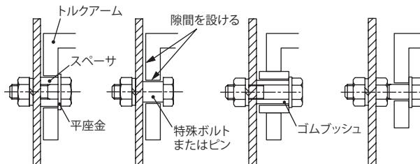
隙間は機械の動きに合わせて、無理な力および接触がかからない寸法に調節してください
