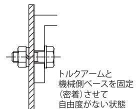
回り止めボルトや機械、本製品に無理な力が働き破損の原因となります
