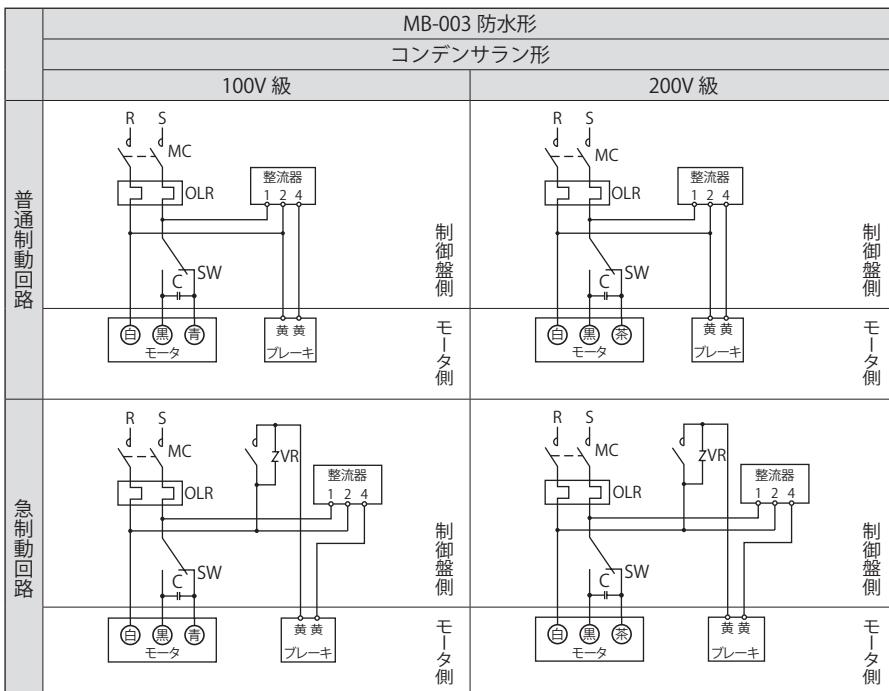
MC : 電磁接触器
