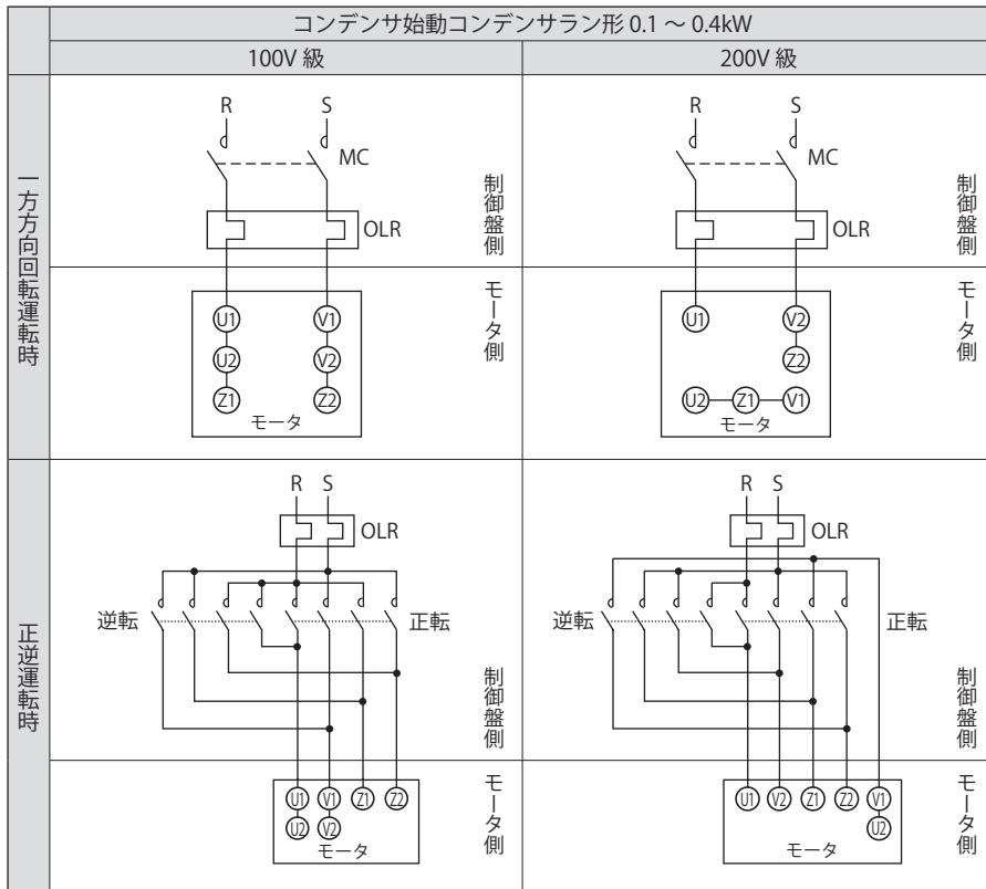
MC：電磁接触器
