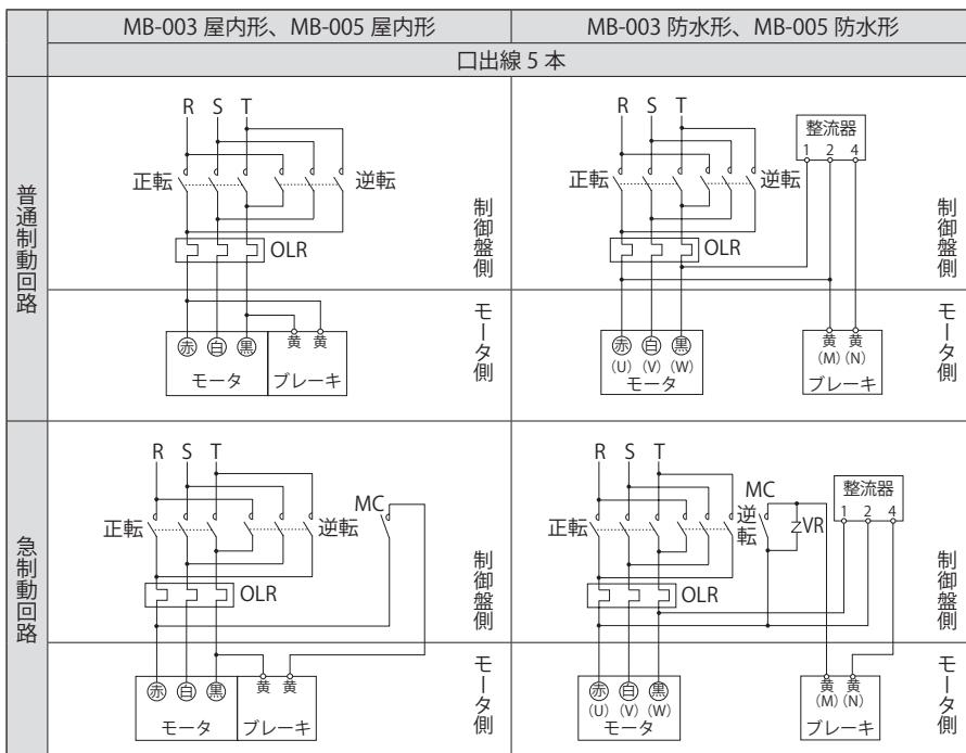
正・逆転用電磁接触器
