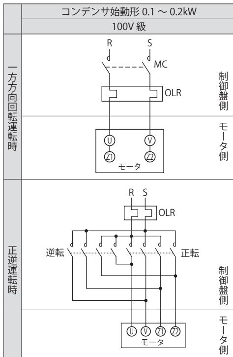
MC : 電磁接触器
