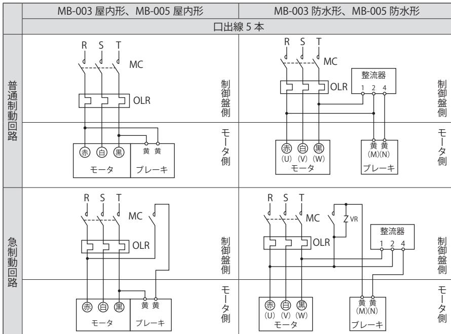
MC : 電磁接触器
