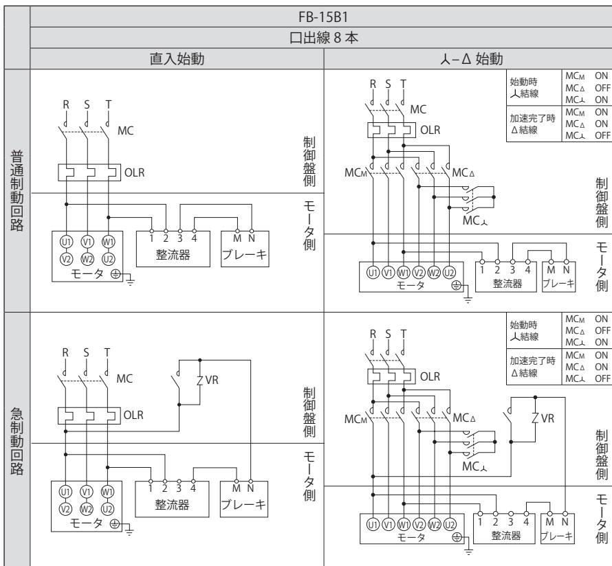
MC : 電磁接触器
