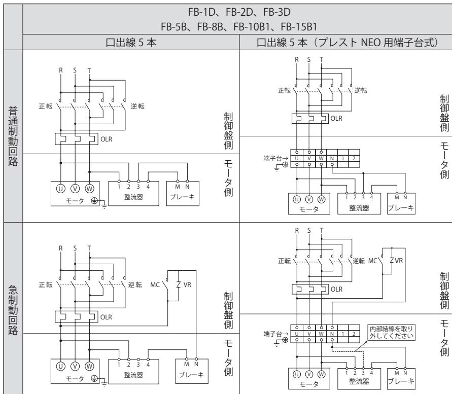
正・逆転用電磁接触器
