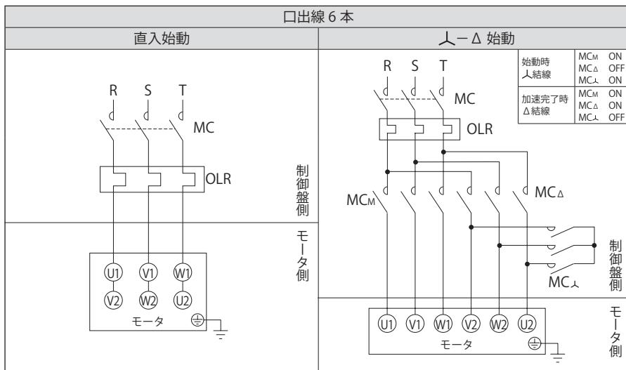
MC : 電磁接触器
