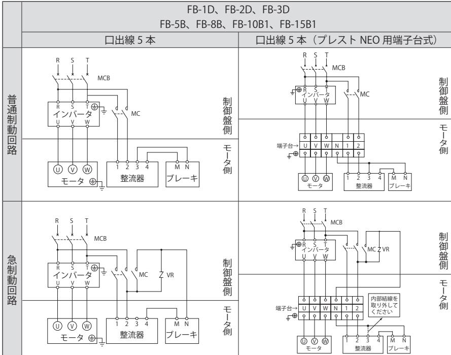
MC : 電磁接触器
