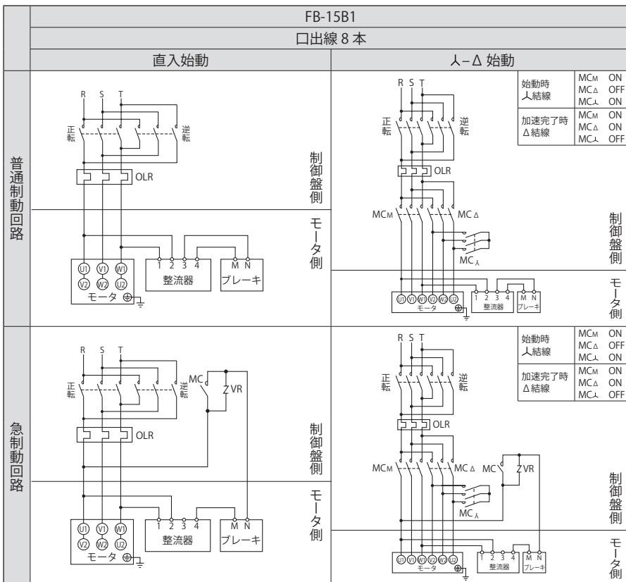
正・逆転用電磁接触器
