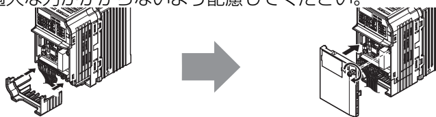
図 3.8 保護カバー類の取付け方法（盤内取付形：IP20）
