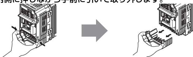
図 3.7 下部カバーの取り外し方法（盤内取付形：IP20）
