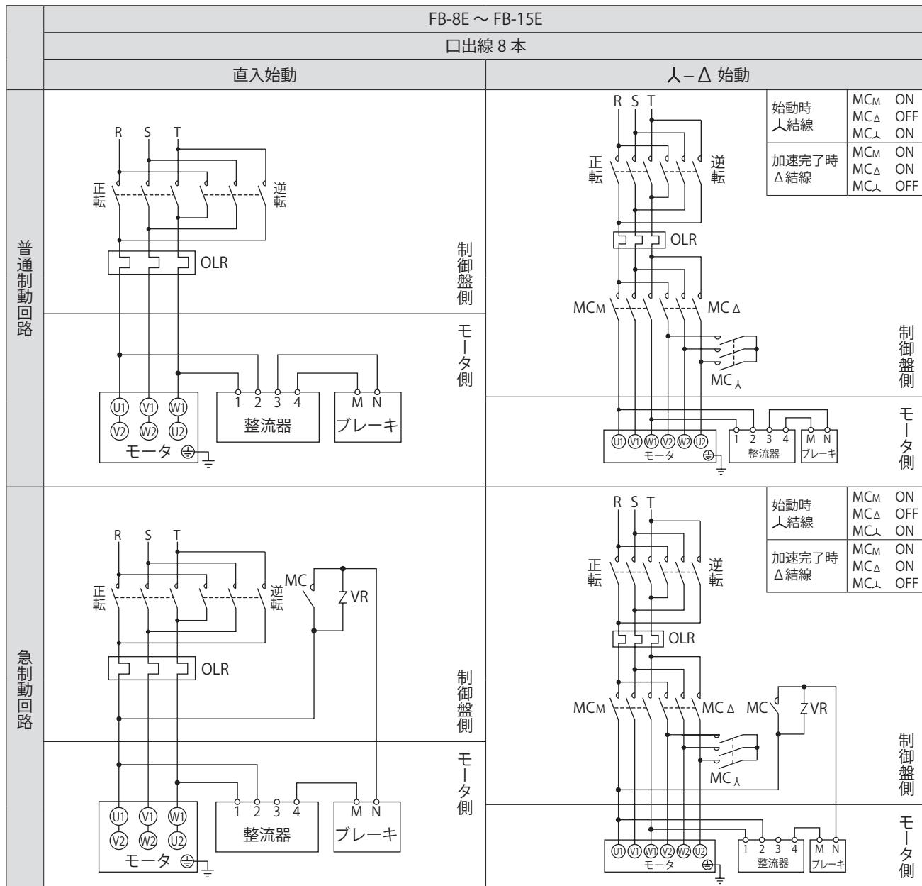
正・逆転用電磁接触器
