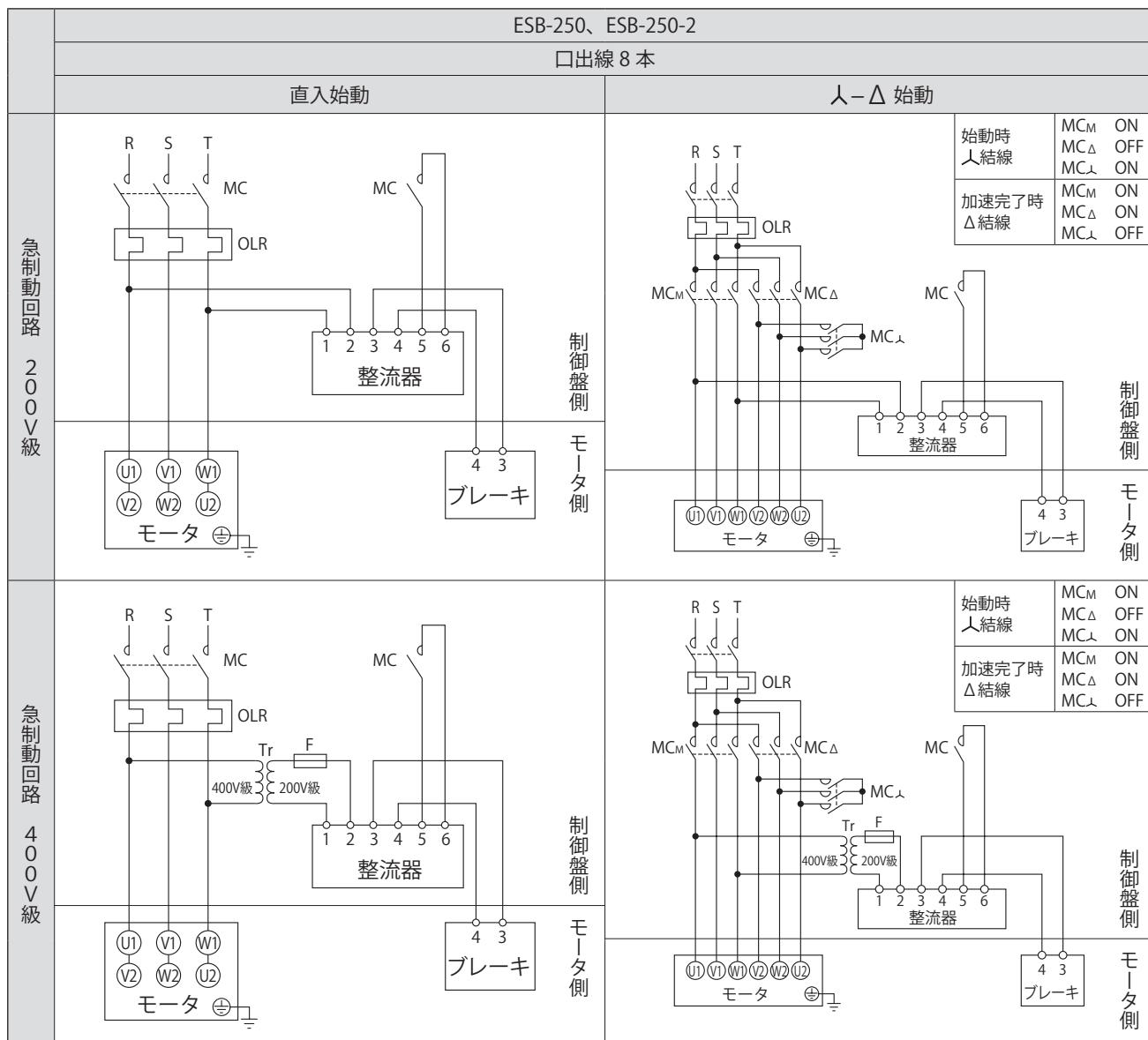
MC : 電磁接触器
