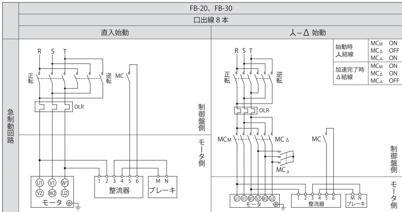
正・逆転用電磁接触器
