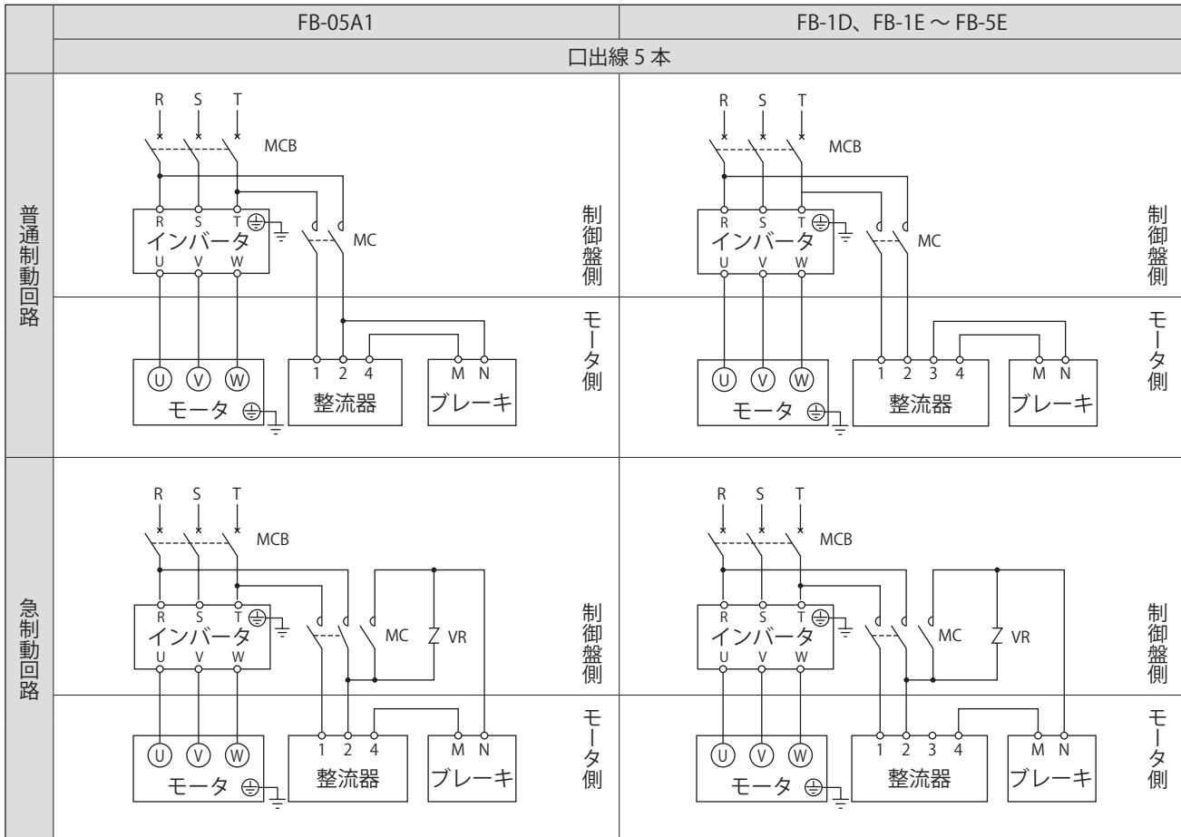
MC : 電磁接触器
