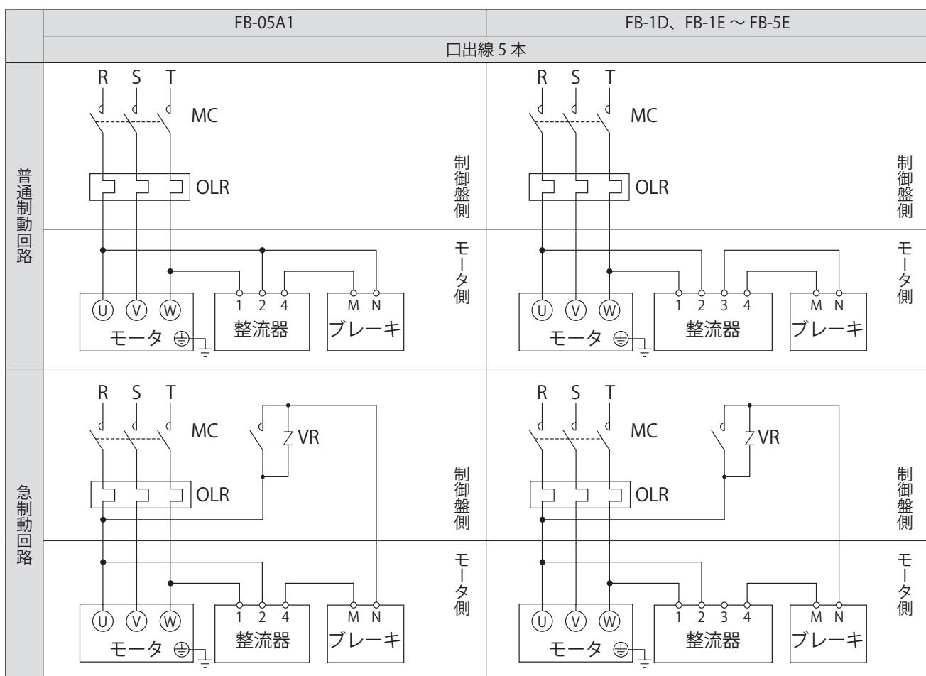
MC : 電磁接触器
