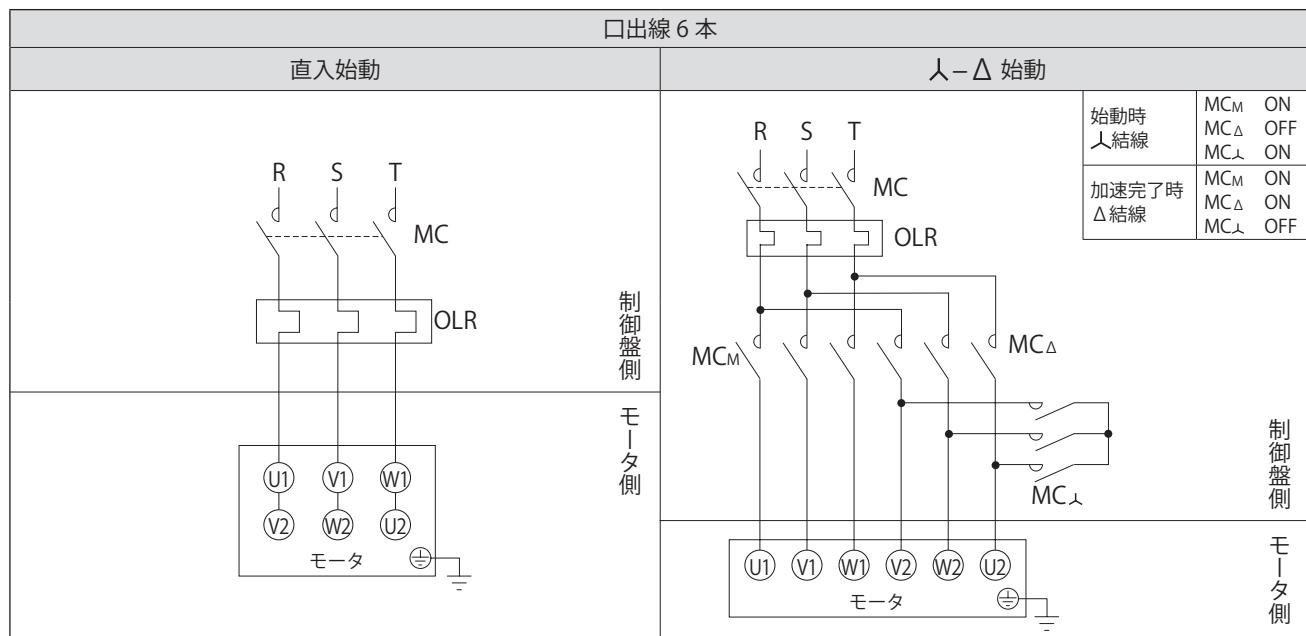
MC : 電磁接触器
