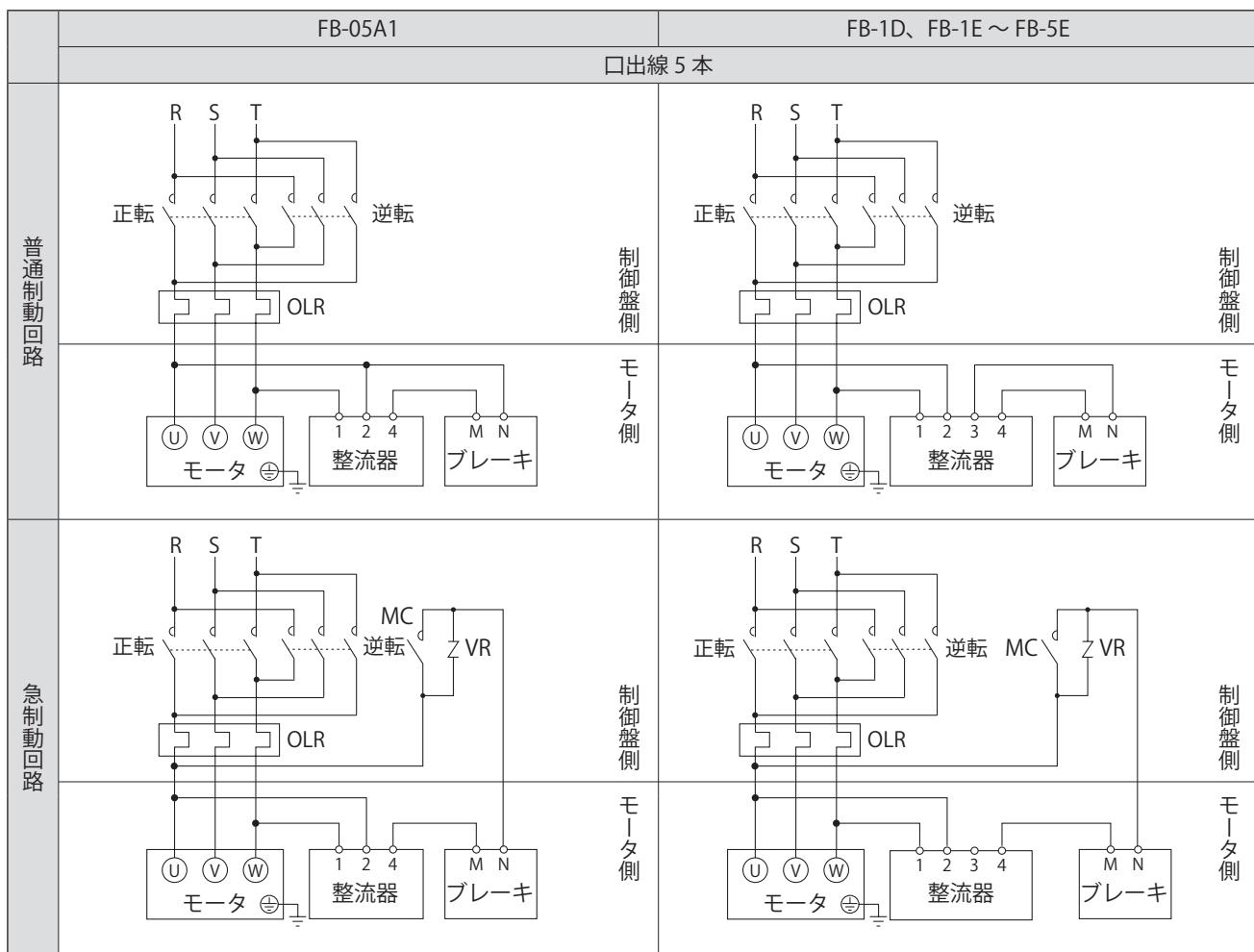
正・逆転用電磁接触器
