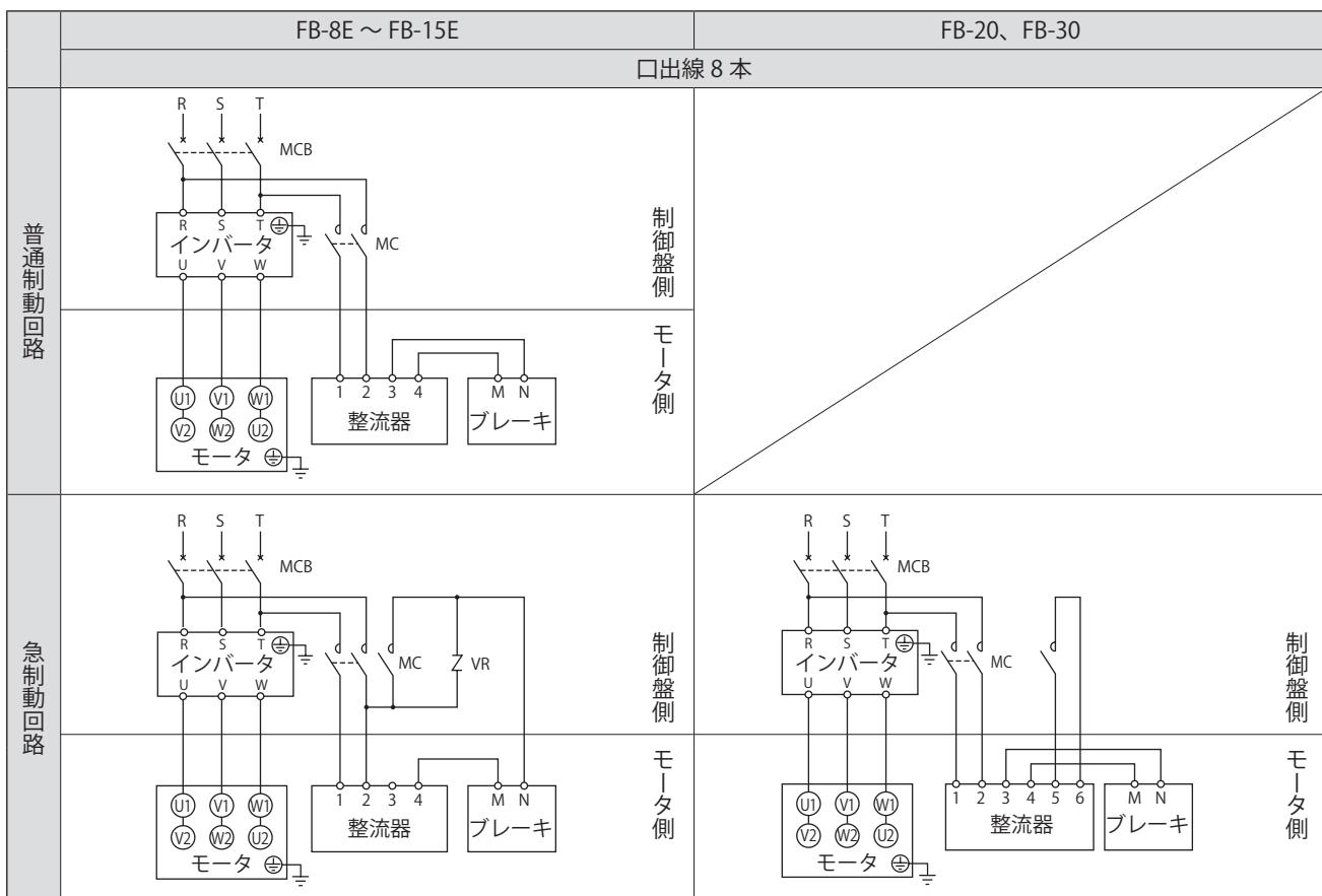
MC : 電磁接触器
