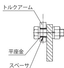
隙間は機械の動きに合わせて無理な力及び接觸がかからない寸法に調整ください。
