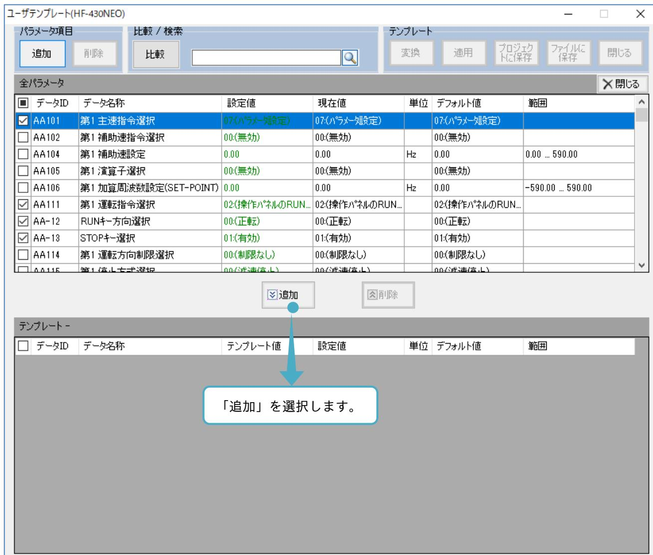
「追加」を選択すると、テンプレートに選択したパラメータとそのパラメータと関連する設定パラメータが追加されます。追加が完了後に全パラメータを閉じます。
