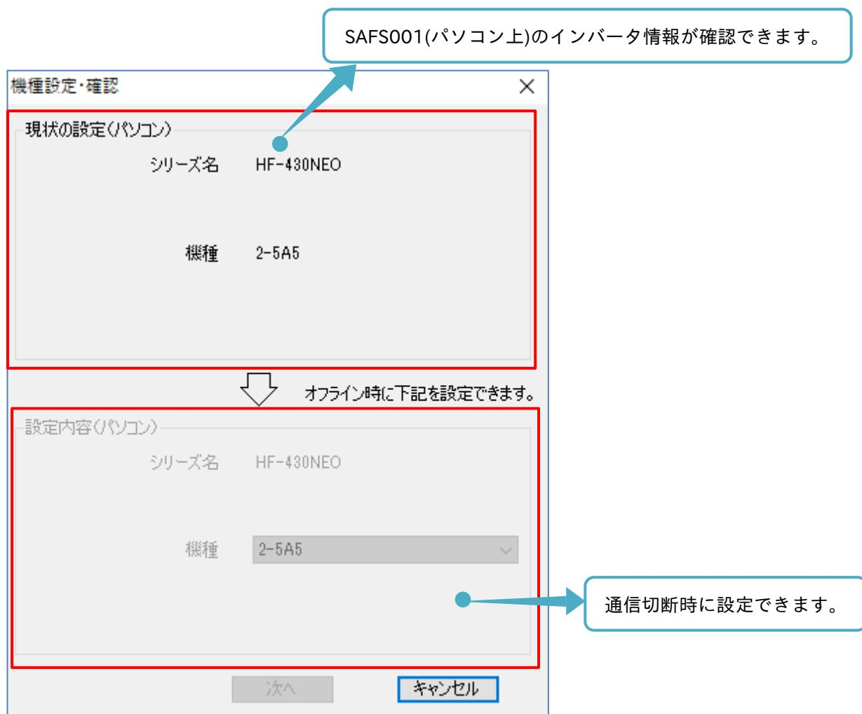
通信切断時に SAFS001 上のインバータ設定を変更できます。
