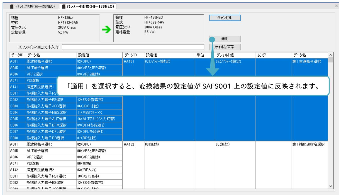
「適用」選択後、パラメータ設定画面を開きます。書き込み(ダウンロード)をすることで、変換された設定値を対象となるインバータに反映できます。
