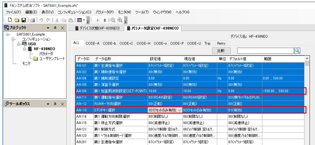
メニューバーのパラメータタブ「全アップロード(デバイス→PC)」の選択、またはエディタ画面のパラメータ設定操作画面で右クリックし、「全アップロード(デバイス→PC)」の選択から、全パラメータを読み出しきれます。
