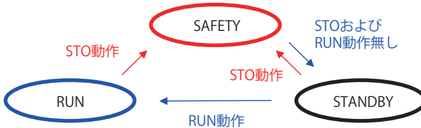
図 5.2 (b) STO の状態機械 (Modbus 仕様ドライバの場合)
