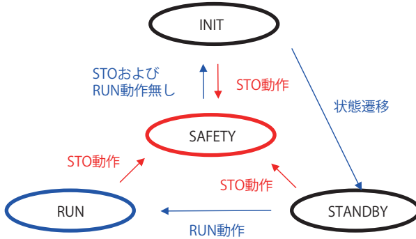
図 5.2 (a) STO の状態機械 (CANopen 仕様ドライバの場合)
