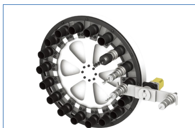
工作機械 マガジン駆動 オートツールチェンジャー (ATC) 駆動
