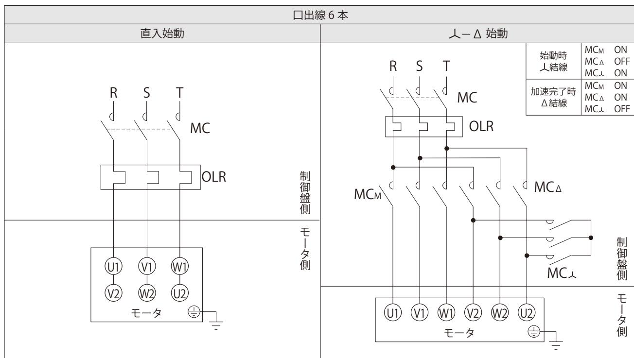
MC : 電磁接触器
